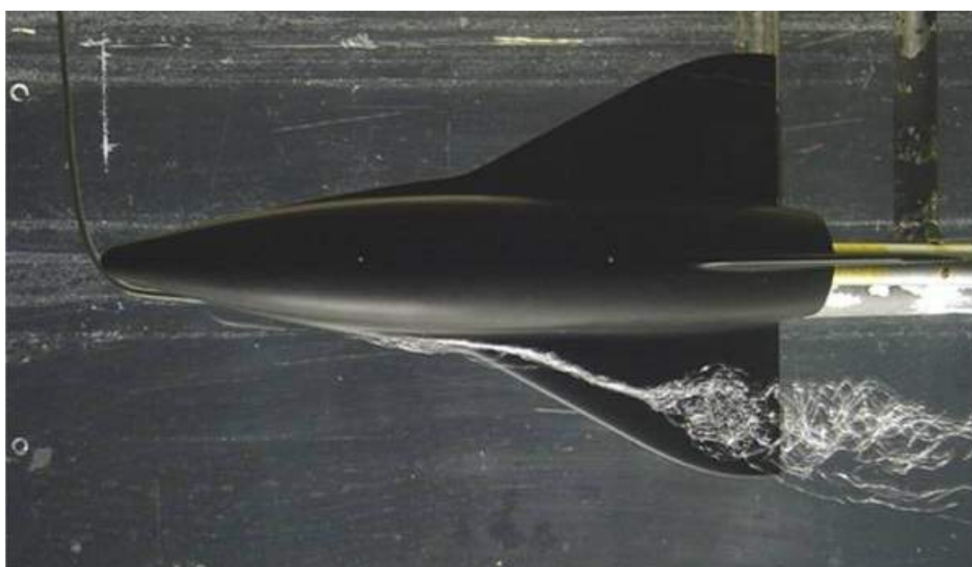
Abbildung 2.10: Lichtbildaufnahme des Aufplatzens der Wirbelschlepe eines schräg angeströmten Deltaflüglermodells. Quelle: Institut für Luft- und Raumfahrt der RWTH Aachen
